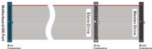
図 2-7. Ultra DMA 66 リボンケーブル
