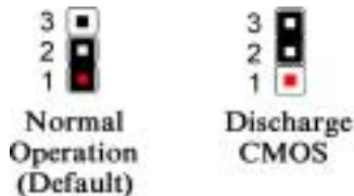
圖 2-7. CCMOS1 跳接頭的設定方式
