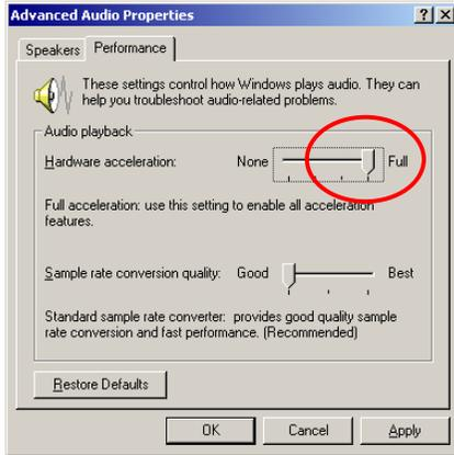
Gehen Sie zu “Start” → “Systemsteuerung” → “Audio und Multimedia” → “Audio” → “Erweitert” → “Leistung”. Bewegen Sie den Schieberegler der “Hardwarebeschleunigung” auf die Position “Maximal”.
