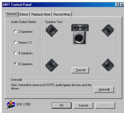
Klicken Sie zum Überprüfen der korrekten Installation aller Lautsprecher auf die Schaltfläche “Alle testen”. Bitte verfolgen Sie die Bewegung der auf dem Bildschirm angezeigten Musiknote aufmerksam, um die korrekte Platzierung Ihrer Lautsprecher zu überprüfen.
