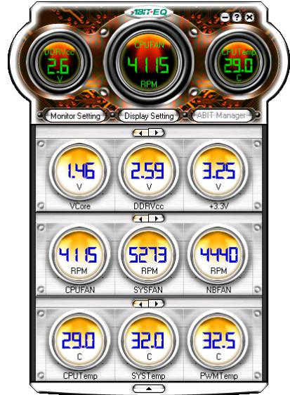
6. Dieser Bildschirm erscheint. Der ABIT EQ zeigt die Statuswerte für Spannung, Lüftergeschwindigkeit und Temperatur.
