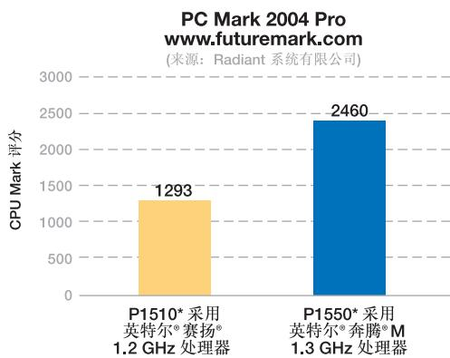
客户体验数据: Radiant 测试使用 PC Mark 2004 Pro 这项基于应用的基准测试来测量 PC 的整体性能，结果显示英特尔奔腾 M 1.3 GHz 处理器平台的性能是英特尔赛扬 1.2 GHz 处理器平台的 1.9 倍。
