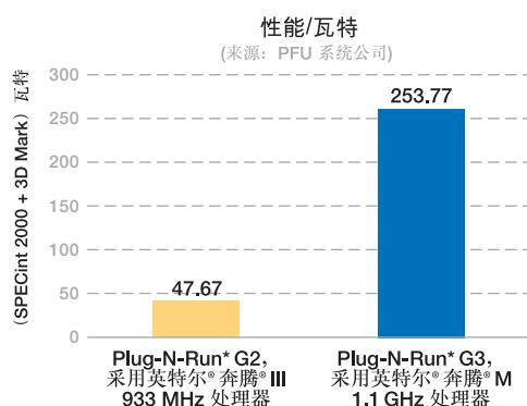
客户体验数据: 这项基准测试针对采用英特尔®奔腾®M 1.1 GHz 处理器的模块和采用英特尔®奔腾®III 933 MHz 处理器的相同模块, 比较了每瓦特的性能。每瓦特性能等同于(SPECint 2000 + 3DMark)/测得的瓦特数 - MAX。
