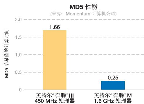
客户体验数据: 测试中对具备英特尔®E7501 芯片组的英特尔®奔腾®M 1.6 GHz 处理器和英特尔®奔腾®III 450 MHz 处理器进行比较; 两套系统均采用 RedHat Linux® 9 操作系统。MD2 实用程序 (Linux 的标准组件) 被用于计算一个容量约为 40 MB 的测试文件的 MD5 哈希函数。该文件被选为测试对象是因为其容量大于处理器的高速缓存英特尔奔腾 M 处理器在 0.250 秒内完成计算; 英特尔奔腾 III 处理器则在 1.656 秒内完成计算。如图所示, 英特尔奔腾 M 处理器的性能约为英特尔奔腾 III 处理器的 6.6 倍。
