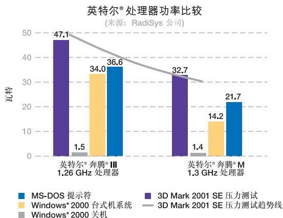
客户体验数据：此图表显示了功耗性能基准测试 – 比较英特尔®奔腾®M 处理器和其它嵌入式处理器。测试中采用 Windows\* 2000 系统为英特尔®奔腾®M 1.3 GHz 处理器和英特尔®奔腾®III 1.26 GHz 处理器测量功耗。
