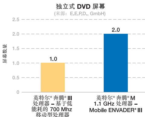
客户体验数据: 这项性能测试涉及到一个采用双屏幕显示功能并处理独立数据流的应用程序。与基于低功耗英特尔®奔腾®III 700 Mhz 处理器的系统相比, 基于英特尔®奔腾®M 1.1 GHz 处理器和英特尔®奔腾®855GME 芯片组的系统明显可发挥更卓越的性能表现。基于英特尔奔腾 M 处理器的系统无需添加第二个处理器主板即可支持双屏显示功能。
