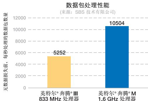
客户体验数据: SBS 技术有限公司通过比较英特尔®奔腾®M processor 1.6 GHz 处理器/英特尔®E7501 芯片组组合与英特尔®奔腾®III 833 MHz 处理器/Serverworks® 3.0 LC 芯片组组合, 评估该处理器提供的性能增益。对于 50 和 90 字节的数据包而言, 基于英特尔奔腾 M 处理器的 WAN 监控设备获取了超过 200% 的直线增长, 同时还提供了更高带宽协议的处理能力。
