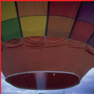
Nuestro globo de aire caliente se eleva debido a la densidad
