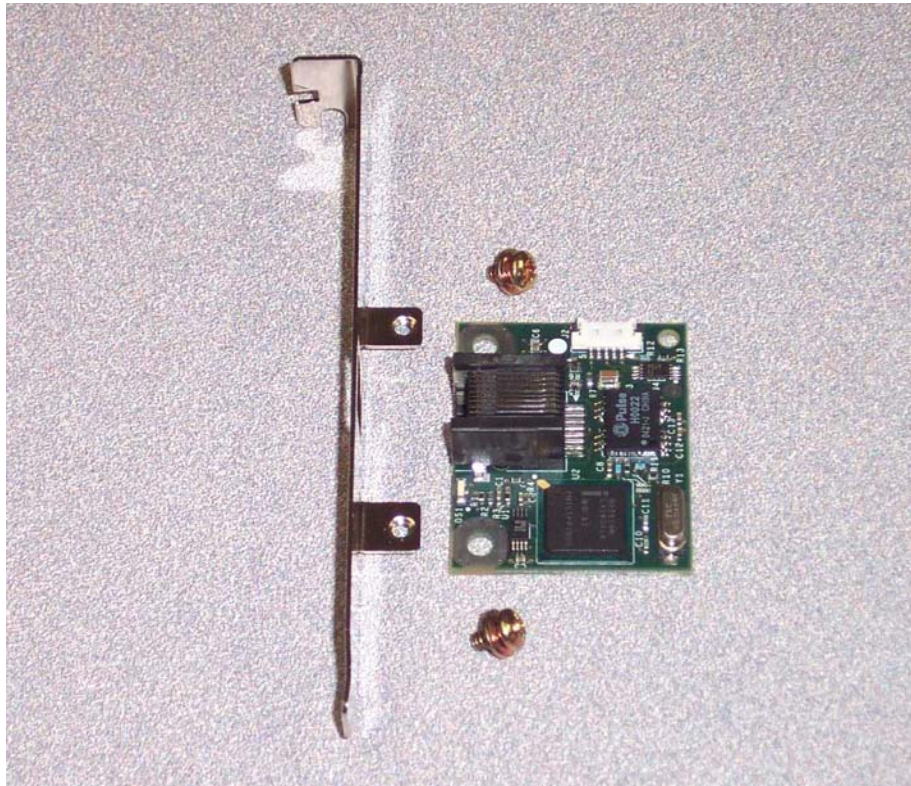
图 7. 英特尔管理模块网络接口卡、填充板和螺丝
