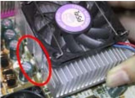
圖 4. 散熱片及風扇的安裝示意圖
