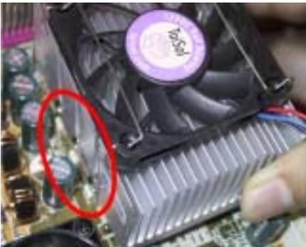
Abb. 4. Installation des Kühlkörpers
