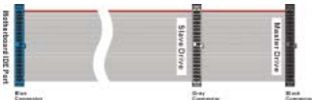
図 2-10. Ultra DMA 66 リボンケーブルの略図
