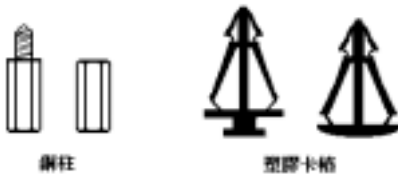
圖 2-3. 銅柱及塑膠卡榫的外觀
