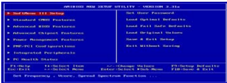
Illustration 3-1. Capture d'écran de l'Utilitaire de Setup en CMOS
