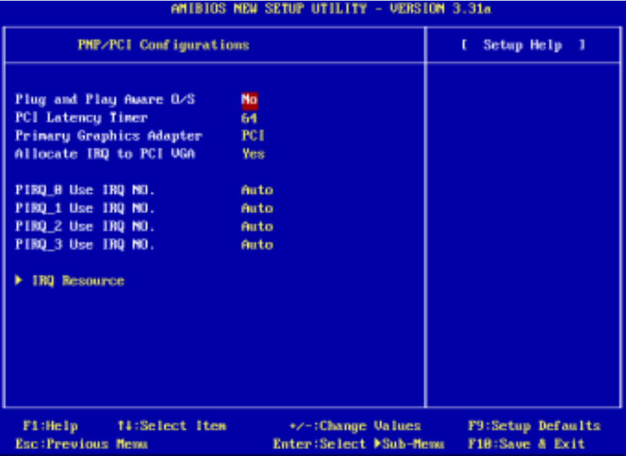
Illustration 3-7A. Menu de Réglages des Configurations PnP/PCI
