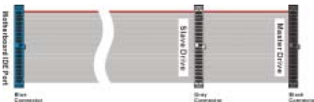
Illustration 2-7. Présentation du câble plat Ultra DMA 66
