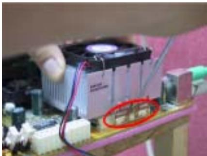
接著請您用手輕微的搖晃一下整個散熱裝置，確認散熱裝置底部右側的溝槽和 Socket 462 腳座的凸起機構部份沒有碰觸到，否則散熱裝置和處理器的晶片之間會有一邊懸空而導致無法散熱。
