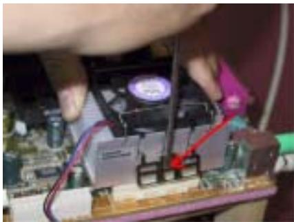
接著使用一字起子插入右側彈片中央處的凹槽，並將彈片朝下用力施壓，以便將散熱裝置右側的彈片卡榫嵌入處理器插槽的右側卡榫之上，如左圖所示。
