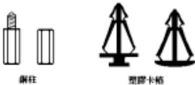
圖 2-3. 銅柱及塑膠卡榫的外觀
