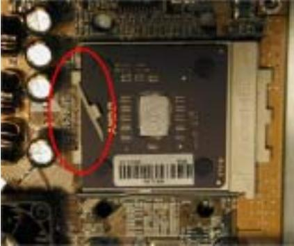
安裝處理器的散熱裝置務必請依照下面所述的順序來安裝，反方向的安裝就有可能造成左圖的情況。因為 Socket A 其中一側的機卡榫機構並沒有另一側來的結實，所以請依照我們建議的順序來做散熱裝置的安裝會比較安全。
