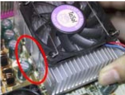
接著將散熱裝置左邊的鐵片卡榫置入處理器插槽左側的卡榫，請確認卡榫已經確實的咬合住，如左圖所示。
