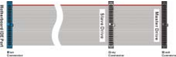
圖 2-9. Ultra DMA 66 纜線的外觀
