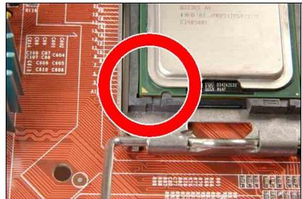
5. Vérifiez visuellement que le processeur est bien installé dans le socle. La languette d'alignement doit être placée dans l'encoche de l'ensemble.
