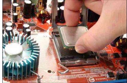
4. De votre pouce et de votre index droit, saisissez l'ensemble processeur. Prenez bien soin de saisir le bord du substrat, et orientez l'indicateur de la Broche 1 en direction du côté inférieur gauche. Alignez avec le socle et insérez l'ensemble processeur à la verticale dans le socle.
