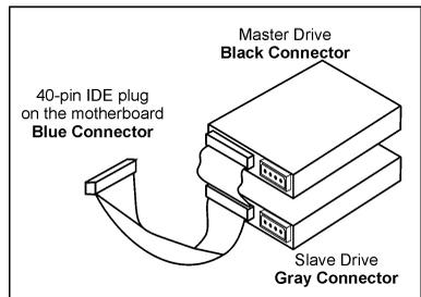
**Remarque:** Veillez bien à configurer correctement la relation "Maître" et "Esclave" avant de connecter deux unités avec un seul et même câble nappe. La ligne rouge sur le câble nappe doit être alignée avec la broche 1 à la fois sur le port IDE et sur le connecteur de disque dur.
