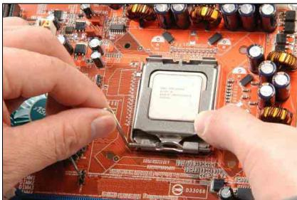
7. Abaissez la plaque sur l'ensemble processeur. Engagez le levier de chargement jusqu'à ce qu'il soit légèrement appuyé contre la plaque de chargement.
