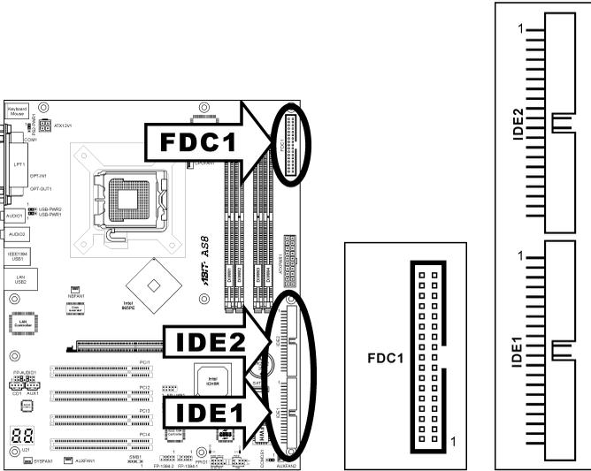
Le connecteur FDC1 permet de connecter jusqu'à deux lecteurs de disquette avec un câble de lecteur de disquettes 34 conducteurs, 2 connecteurs. Connectez l'extrémité simple sur l'extrémité longue du câble nappe sur le connecteur FDC1 de la carte, les deux connecteurs de l'autre extrémité sur le connecteur des lecteurs de disquettes. En général, vous n'avez besoin que d'un lecteur de disquette dans votre système.
