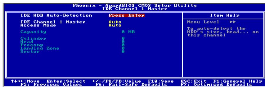
**Remarque:** Les éléments “IDE Channel 3 Master” et “IDE Channel 4 Master” n’apparaissent que lorsque l’élément “OnChip Serial ATA” dans le menu “OnChip IDE Device” est programmé sur [Mode Amélioré], et que l’élément “OnChip Serial ATA Mode” dans le menu “OnChip IDE Device” est programmé sur [IDE].
