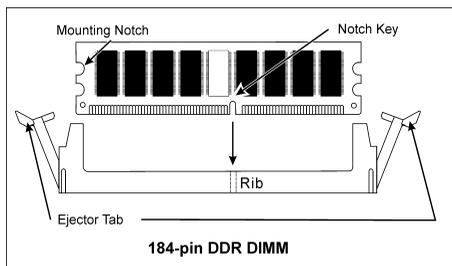
5. Pour retirer les modules DIMM, poussez simultanément les deux onglets d'éjection du slot, puis retirez le module DIMM.
