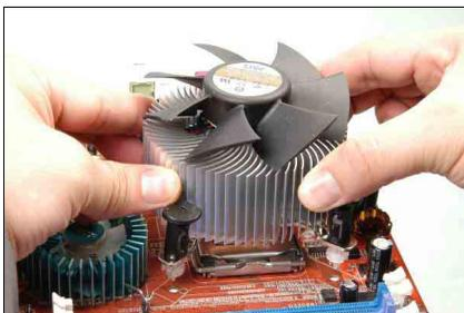
9. Placez l'ensemble dissipateur thermique et ventilateur sur le socle. Alignez les quatre attaches sur les quatre orifices de montage sur la carte mère.
