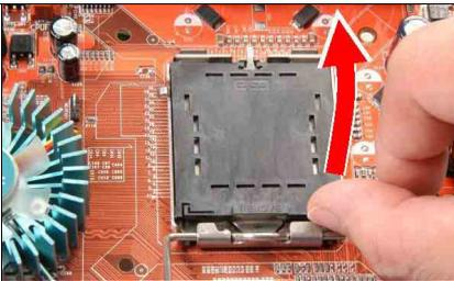
3. De votre pouce droit placé sur la plaque de chargement sur le côté inférieur droit, soulevez la plaque pour la mettre en position ouverte maximum.
