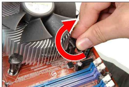
11. Faites pivoter l'attache dans le sens des aiguilles d'une montre pour verrouiller l'ensemble dissipateur thermique et ventilateur en position.
