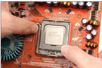
8. Fixez le levier à l'aide du crochet sous la languette de retenue.
