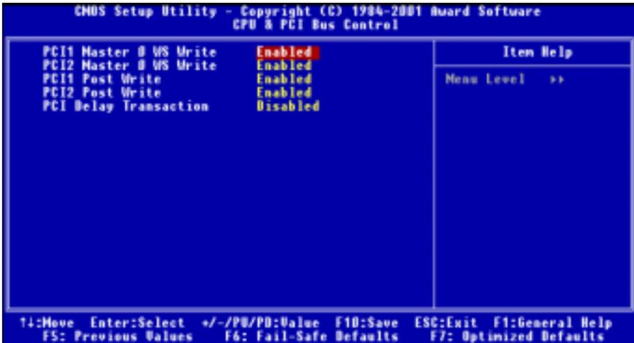
Figure 3-5D. Ecran Contrôle du CPU & Bus PCI
