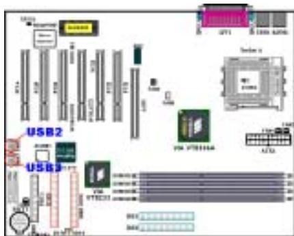
Ce connecteur permet de connecter des prises pour port USB supplémentaires. Vous pouvez utiliser le câble spécial d'extension du port USB (UB-20). Il dispose de quatre prises USB supplémentaires. Ces prises USB peuvent être fixées sur le panneau arrière.
