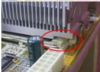
La photo de gauche vous montre la base droite du dissipateur entrant en contact avec le côté droit du socket. Dans cette situation, la surface du CPU n'est pas entièrement en contact avec le dissipateur. Si vous démarrez le système à ce moment là, votre processeur sera immédiatement endommagé. Vérifiez toujours ce point à la fin de l'installation du dissipateur.
