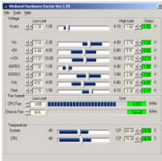
Cet écran montre l'écran du système de surveillance du matériel. Il affiche des informations relatives à la température du système, aux tensions et aux vitesses des ventilateurs. Certains éléments vous permettent de régler les bornes pour les alertes; vous pouvez optimiser les valeurs en les réglant en fonction de votre système.
