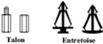
**Figure 2-1. Schéma d'un talon et d'une entretoise**
