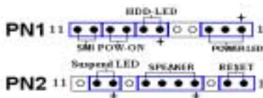
Figure 2-9. Définitions des pins des PN1 et PN2
