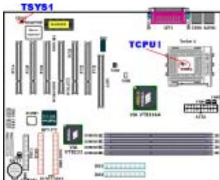
Le TCPUI est utilisé pour détecter la température du CPU. Le TSY1 est quant à elle utilisé pour capter celle de l'environnement ambiant. Vous pouvez voir les données relevées par ces sondes dans le BIOS ou l'utilitaire de surveillance.
