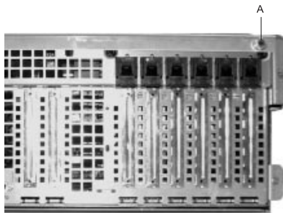
Figura 15. Una delle due viti di fissaggio del coperchio superiore
