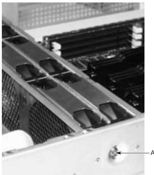
Figura 30. Una delle due viti di fissaggio del gruppo di schede di ventilazione
