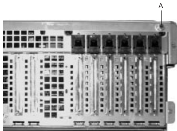
Figura 2. Una delle due viti di fissaggio del coperchio superiore
