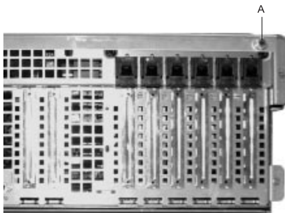
Figura 13. Una delle due viti di fissaggio del coperchio superiore
