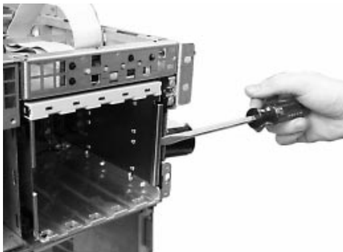
Figura 33. Estrazione dell'alloggiamento per dischi rigidi dal telaio
